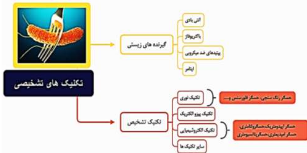
شکل ۵- معرفی انواع گیرنده های زیستی و حسگرهای تشخیص سالمونلا (شن و همکاران، ۲۰۲۱)
